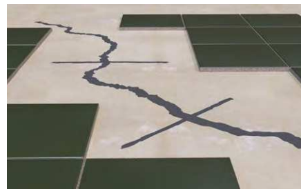
Sigillatura di fessure.
