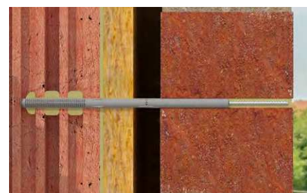
Dettaglio: Risanamento della muratura esterna.
