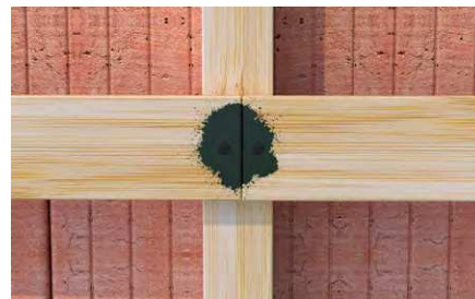
Sigillatura della testa delle viti.
