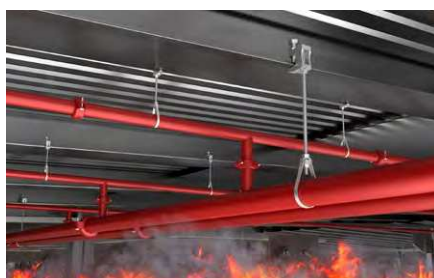
Impianti antincendio Sprinkler.
