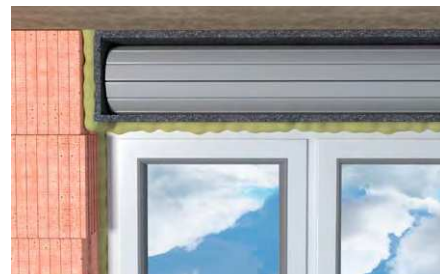
Giunti di connessione intorno ai cassonetti.
