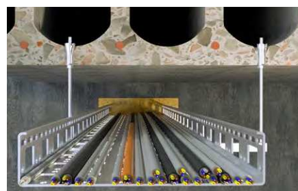
Passerelle portacavi su solai in calcestruzzo precompresso alveolare.
