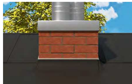
Sigillatura intorno a tetti con guaine bituminose.
