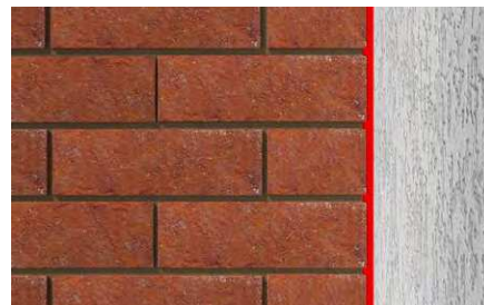
Giunti soggetti a forti dilatazioni.
