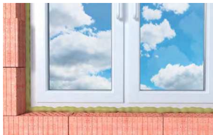
Giunti di connessione di serramenti.
