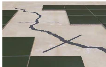
Sigillatura di fessure.
