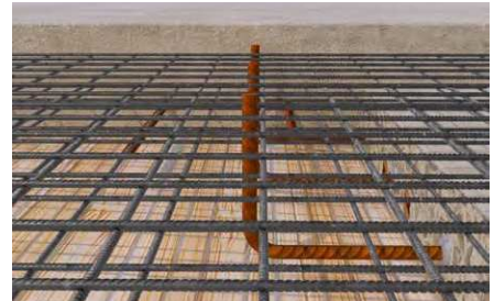
Conessioni di barre di armatura.
