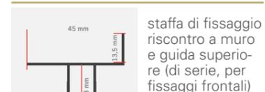
staffa di fissaggio riscontro a muro e guida superiore (di serie, per fissaggi frontali)
