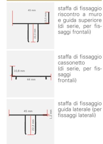
staffa di fissaggio riscontro a muro e guida superiore (di serie, per fissaggi frontali)
