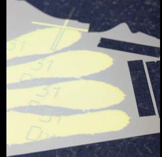
3 TAGLIO LASER COMPONENTI Component laser cutting / Laserschneiden von Bauteilen
